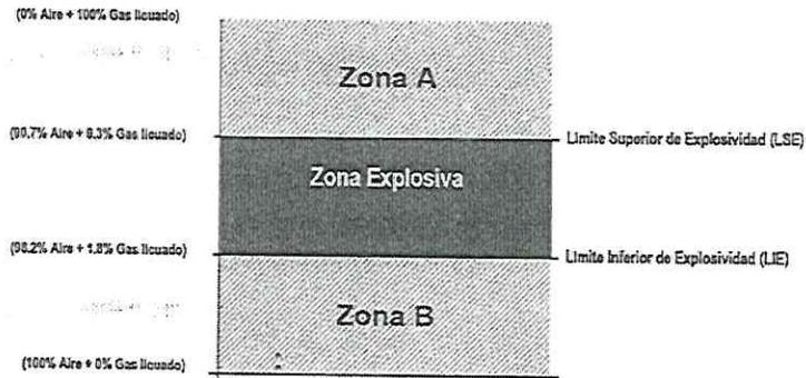
Punto 1 = 20% del LIE.- Valor de ajuste de las alarmas en los detectores de mezclas explosivas.
